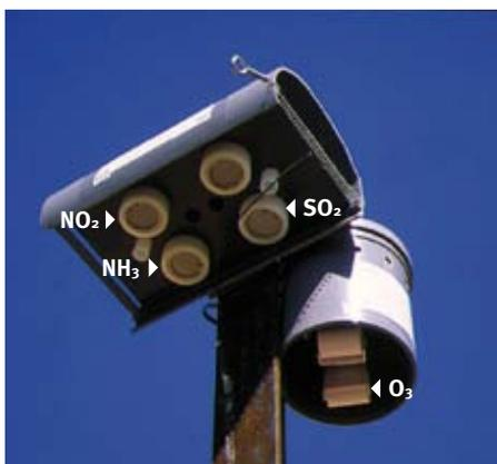
Vista, desde abajo, del soporte para dosímetros pasivos. Una carcasa aloja los captadores de Dióxido de Nitrógeno ( $\text{NO}_2$ ), Amoníaco ( $\text{NH}_3$ ) y Dióxido de Azufre ( $\text{SO}_2$ ), y la otra los de Ozono ( $\text{O}_3$ ).
