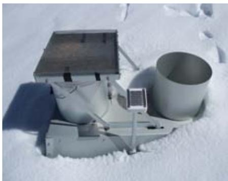
Captador de partículas pasivo para deposición húmeda (izq.) y seca (dcha.) parcialmente enterrado por la nieve. Estación multiparamétrica de Veleta, Sierra Nevada.
